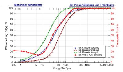
Darstellung der Ergebnisse der Mühlenbilanz (Bilanz über das Mühlenmodell 13 mit der Kennkurve der Energiecharakteristik
