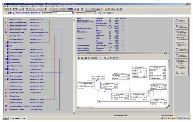
In der vorliegenden Abbildung ist ein Projekt dargestellt, dass eine komplexe Bilanzaufgabe im einfachen Mahlkreislauf löst. Auf der linken Seite stehen die Datenstrukturen für die Lösung dieser Aufgabe zur Verfügung. Als Ausgang dienen die gemessenen Informationen (INPUT) vom
