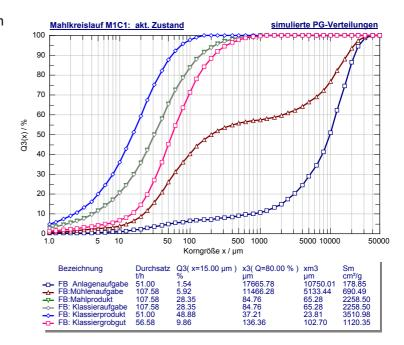
Bewertung der Messdaten des Mahlproduktes durch den Vergleich der gemessenen PG-Verteilung des Produktes mit der PG-Verteilung, die sich durch die Simulation im stationären Zustand ergibt. Die Grundlage bilden Apparatekennkurven, die sich aus den Bilanzen im stationären Zustand ergaben.
