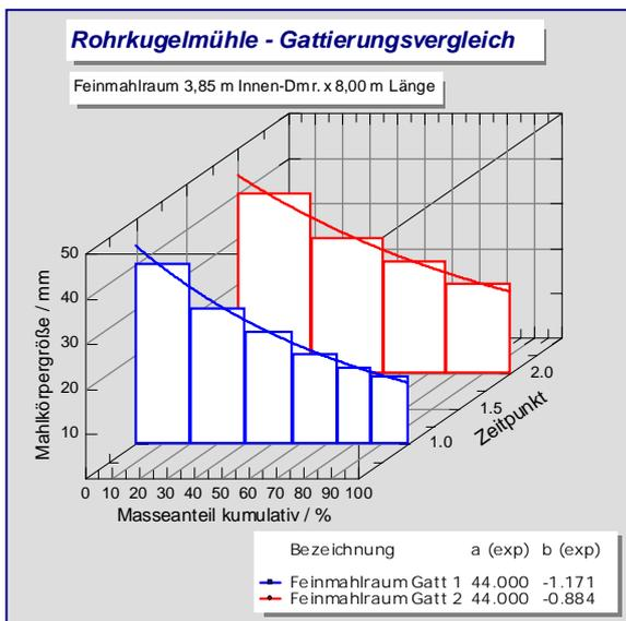
PMP stellt das **Gattierungsdiagramm** als spezifische Diagramm Ansicht zur Verfügung. Diese Ansicht kann als zweidimensionales xy-Diagramm oder zu Vergleichszwecken optional auch dreidimensional gewählt werden, s. Bild.
